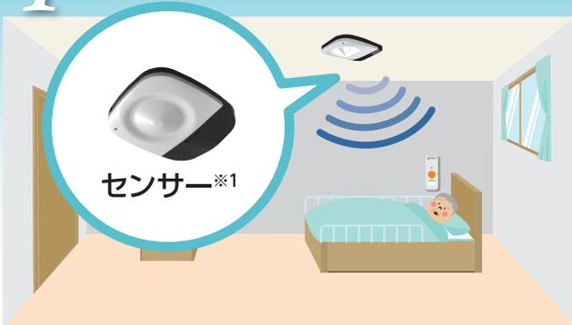
※1:センサーは、ご入居者様の起床・離床、転倒/転落などを検知し、スタッフのスマートフォンへ通知します。
